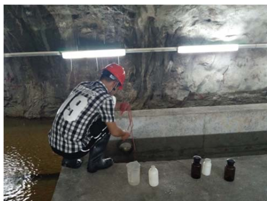
地下厂房含油废水采样
