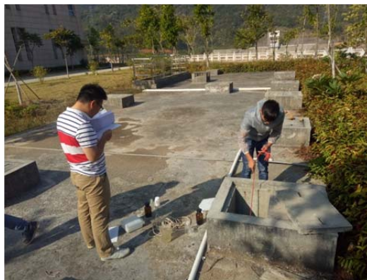
下库管理中心生活污水采样
